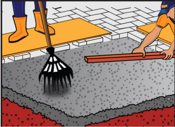
Figura 7. Uniformidad de la superficie de la cama de arena de asiento
