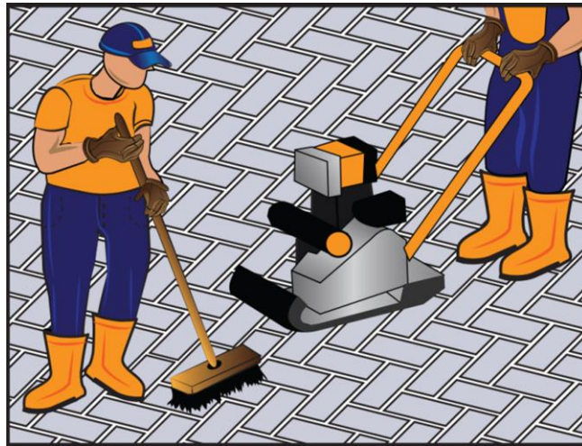
Figura 16. Sellado de juntas
