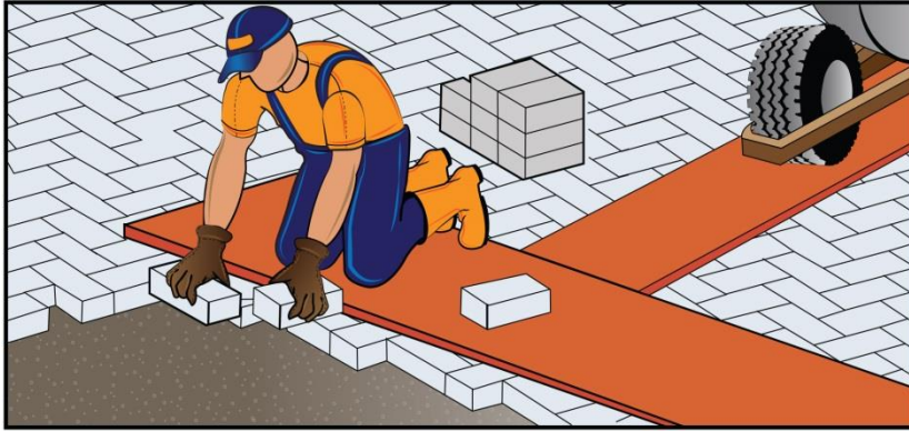
Figura 12. Colocación de los tramos del pavimento
