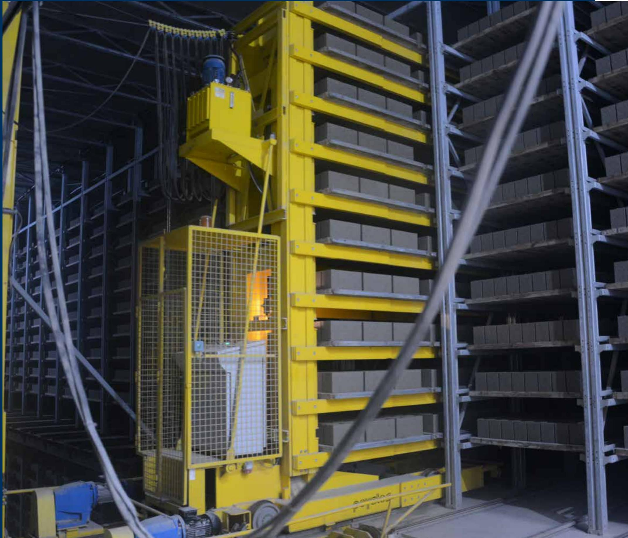
Con un cuarto de curado que por medio de la circulación de aire nos permite controlar la humedad y temperatura de secado, con lo que logramos un producto más estable, que cumple con la norma y a un precio justo.
